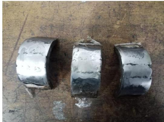
**Gambar 5.** spesimen yang sudah di uji bending
