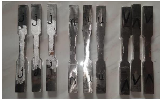
Gambar 2. Hasil Pengelasan TIG
